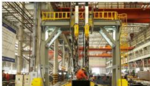
桥梁杆件主焊缝自动化焊接系统
