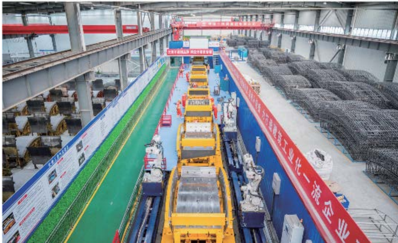
中铁十四局数字化预制构件厂（第二海底隧道直径 16 m 管片生产）
