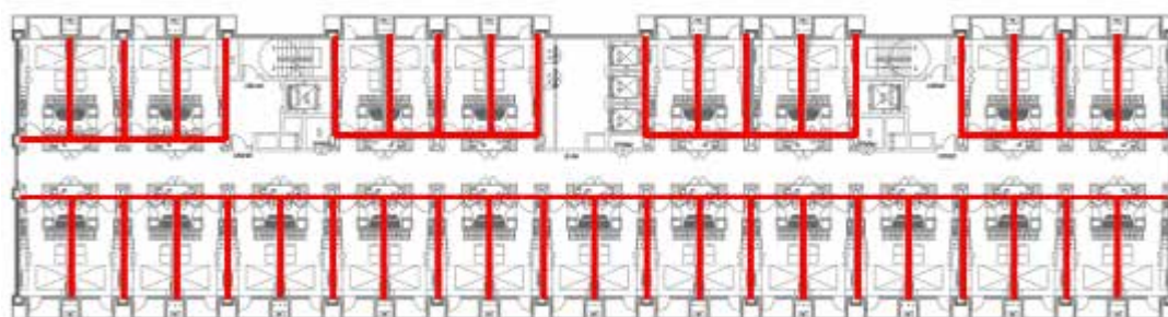
增韧发泡内隔墙板使用位置
