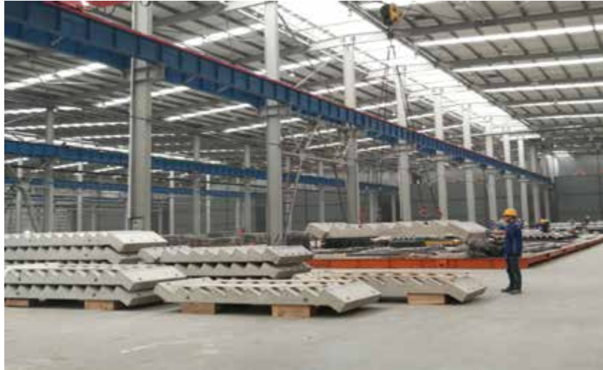
预制装配式钢筋混凝土板式楼梯
