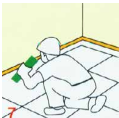
图七地板钉钉固定、封边
