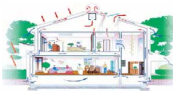
轻钢房屋的双层空气层构造体系
