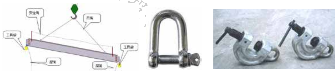
钢梁吊装示意图及专用夹具
